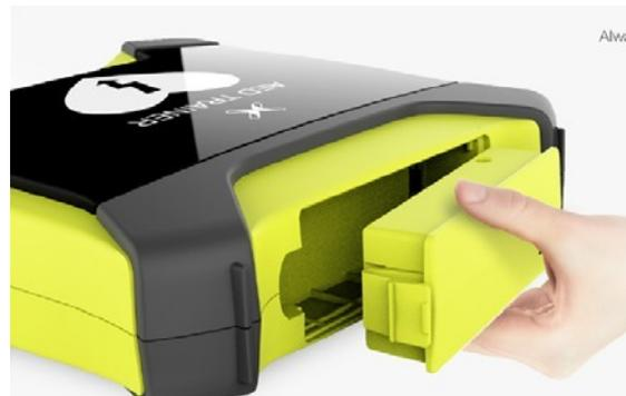
Fig.6 Retirer le module de batterie
