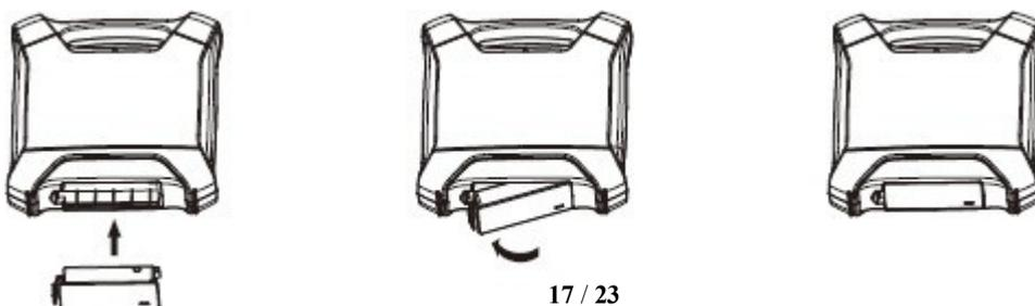
Fig. 32 Installation de la batterie
